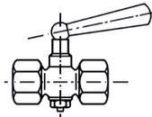
Zapfen / Spannmuffe mit Prüfzapfen M 20 x 1,5
