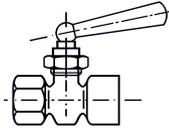
Muffe / Muffe mit Prüfflansch 60 x 25 mm
